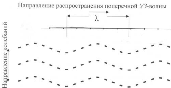
Рис. 1.4 - Процесс распространения поперечной УЗ-волны
