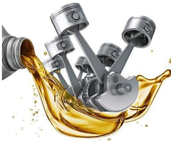
Рисунок 2.17 – Отвод тепла и удаление продуктов износа от поршней и других частей двигателя
