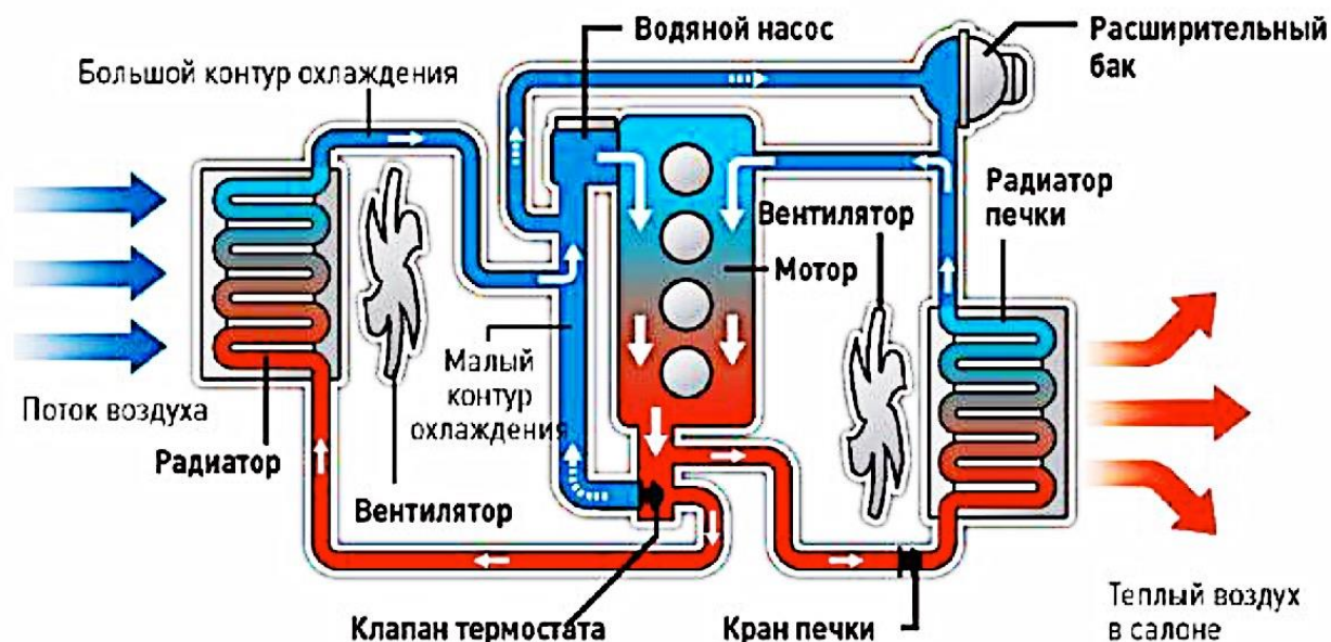
Рисунок 2.8 – Система охлаждения ДВС
